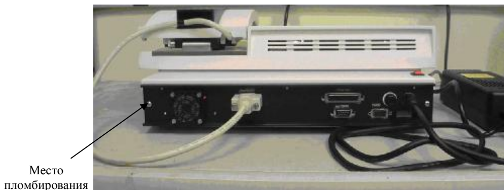
Рисунок 6 – Рефрактометры автоматические цифровые (вид сзади)
